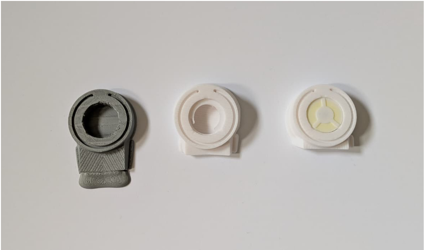
3D-gedruckter Prototyp zur Einstellung der Toleranzen der Hauptleuchte Martin Dück
