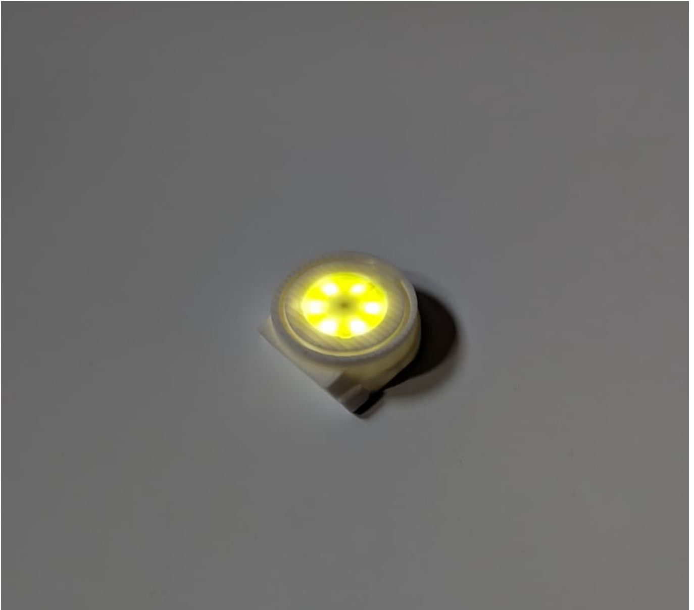
3D-gedruckter Prototyp zur Einstellung der Toleranzen der Hauptleuchte Martin Dück
