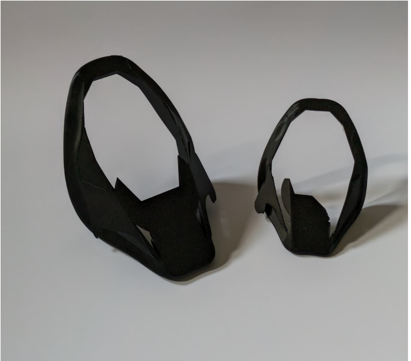
3D-gedruckte Prototypen zur Erstellung einer idealen Passform Martin Dück
