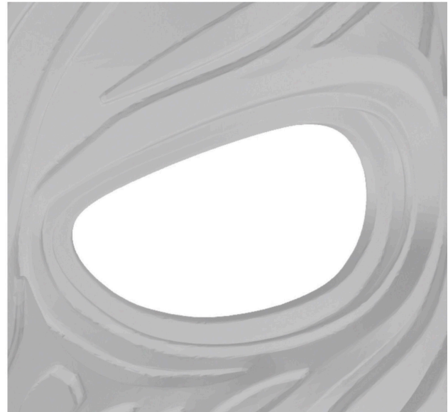
Abb. 27, (von oben links nach unten rechts) Snap-Fit-Kanal Visier, Öffnung für LED, Nut-und-Feder-Geometrie an der Schnittkante, Visieröffnung | eigene Ausarbeitung, Selina Kartal
