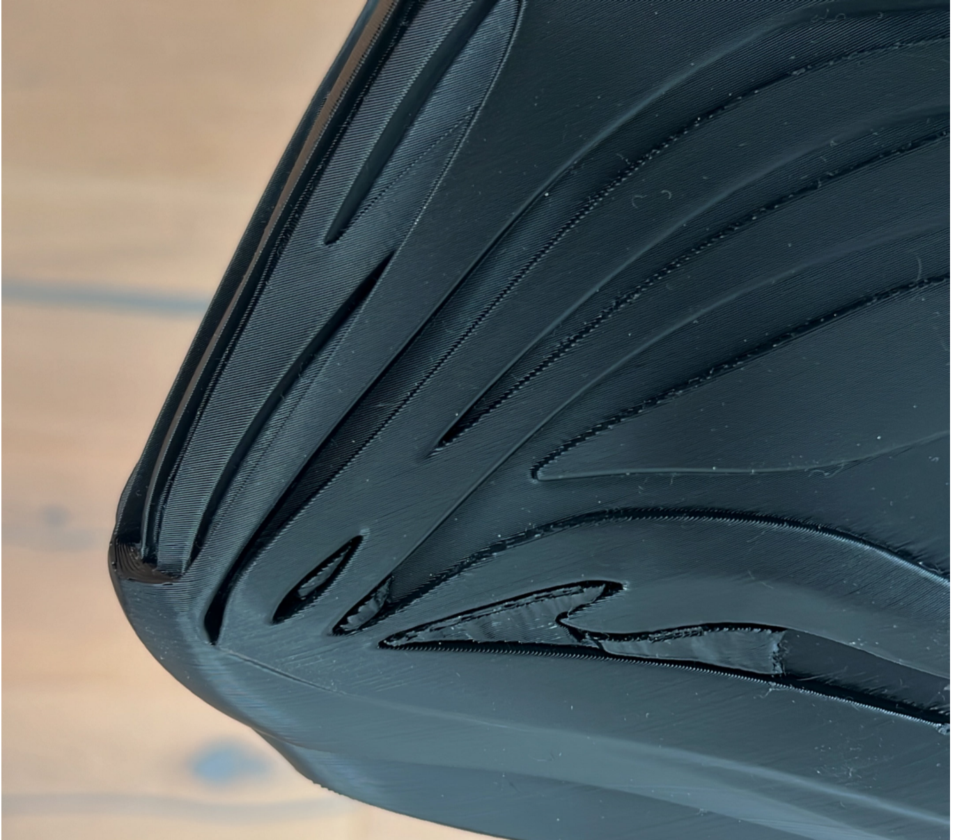
Abb. 37, Nachbearbeitung des 3D-gedruckten Helms, Entfernen von Stützmaterial | Selina Kartal
