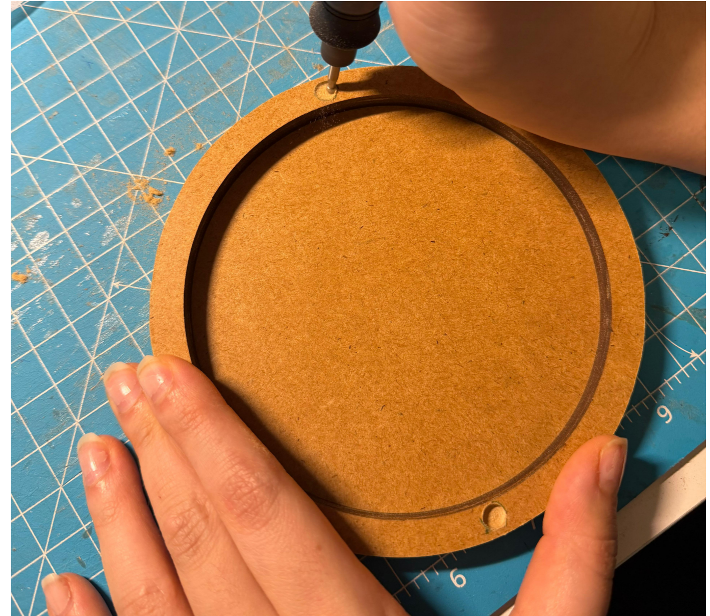
Das Einfräsen von Löchern in den Sockel für die Magneten | Belinay Sahan
