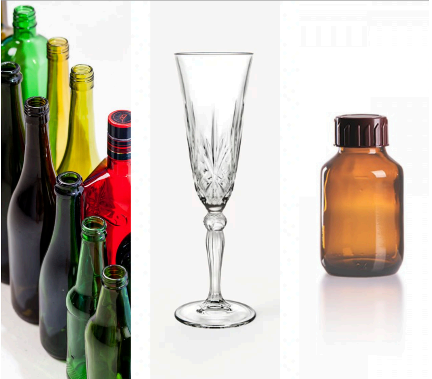
Drei Glasarten links: Kalknatronglas, mittig: Kristallglas, rechts: Borosilikatglas 1
