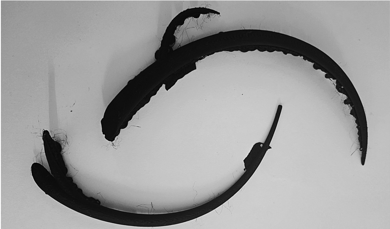
3D-Druck ohne Nachbearbeitung | Foto: Elif Can
