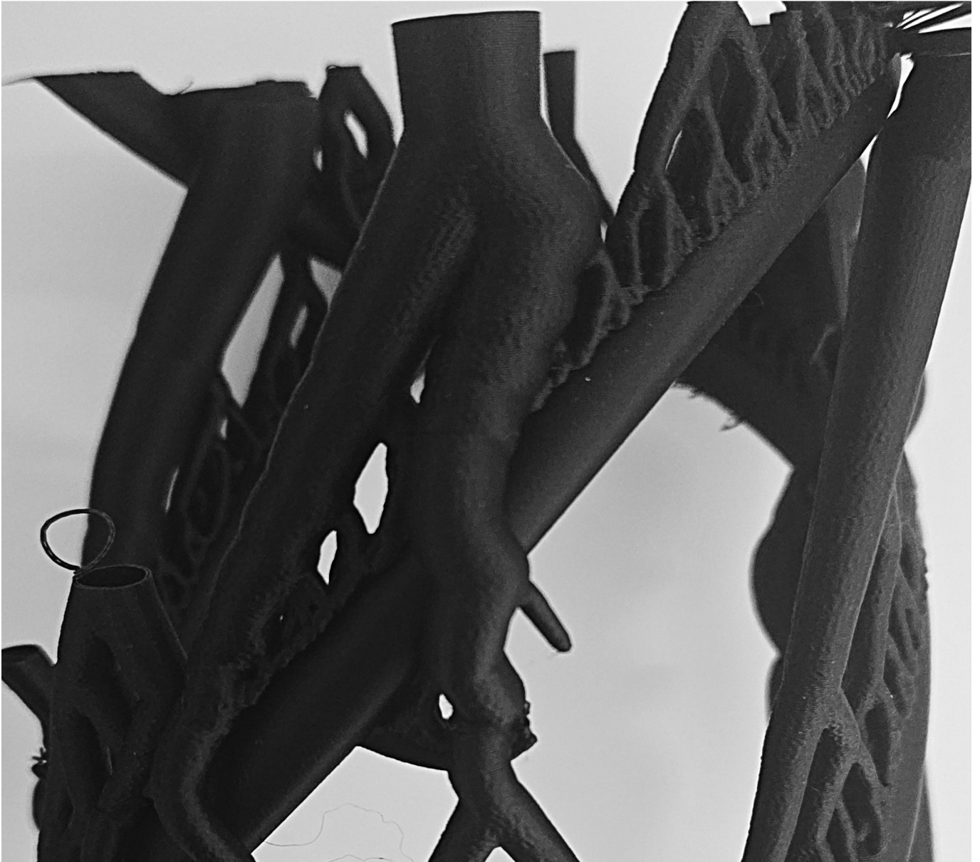
3D Druck ohne Nachbearbeitung | Foto: Elif Can
