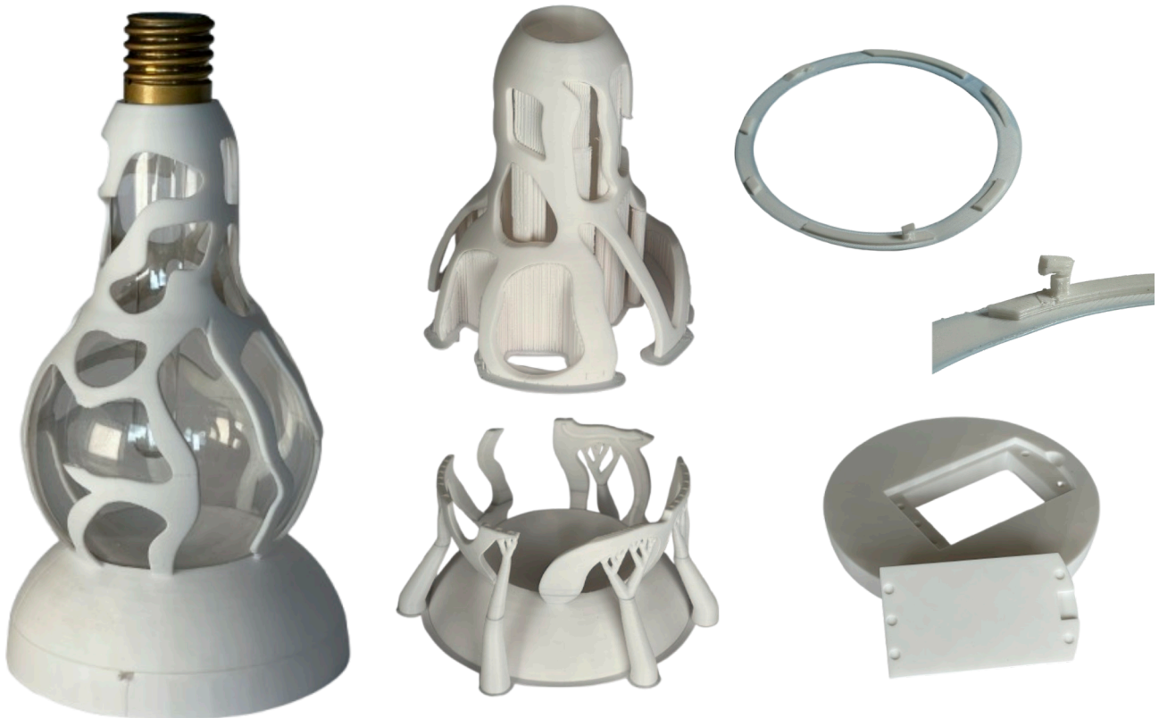
Testdrucke des 3D-Modells mit Stützmaterial | Q8 (Impro-Fotostudio im DMA Innovation Lab)
